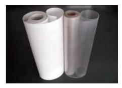
PLA(聚乳酸)是一种新型的生物基及可再生生物降解材料,使用可再生的植物资源(如玉米、木薯等)所提出的淀粉原料制成。聚乳 酸的热稳定性好,加工温度170~230℃,有好的抗溶剂性,由聚乳酸制成的产品除能生物降解外,生物相容性、光泽度、透明 性、手感和耐热性好,还具有一定的耐菌性、阻燃性和抗紫外性,因此用途十分广泛,可用于水果,蔬菜,鸡蛋,熟食和烘烤食 品的硬包装,也可用于三明治,饼干和鲜花等商品的包装。
